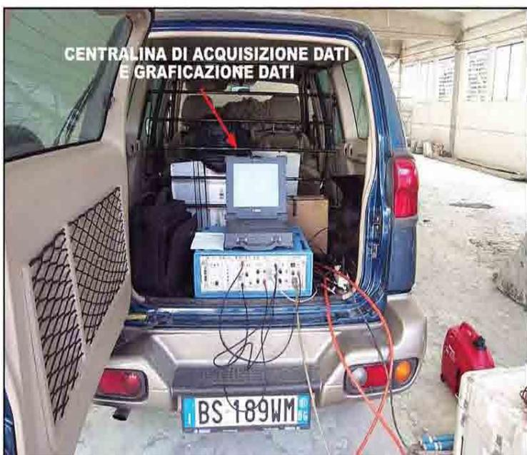
Particolare della centralina di acquisizione dati (stampabili direttamente al termine della prova)
