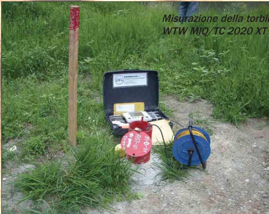
*Misurazione della torbidità in foro (turbidimetro WTW MIQ/TC 2020 XT – IQ SENSOR NET).*
