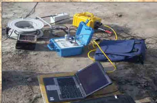
Questo tipo di indagine sfrutta la possibilità di inserire i sensori sismici all'interno dei fori di sondaggio per ottenere misurazioni di velocità più precise in relazione ai terreni investigati.
