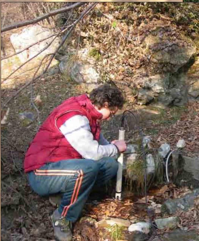
Il prelievo di campioni di acqua viene eseguito mediante l'utilizzo di una pompa centrifuga ad immersione a 12V.
