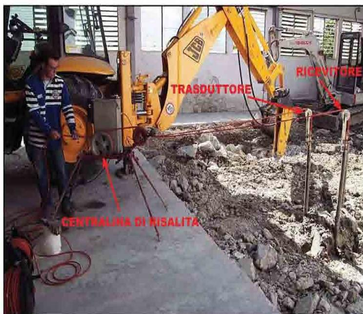
Fase di acquisizione su una sezione di controllo
