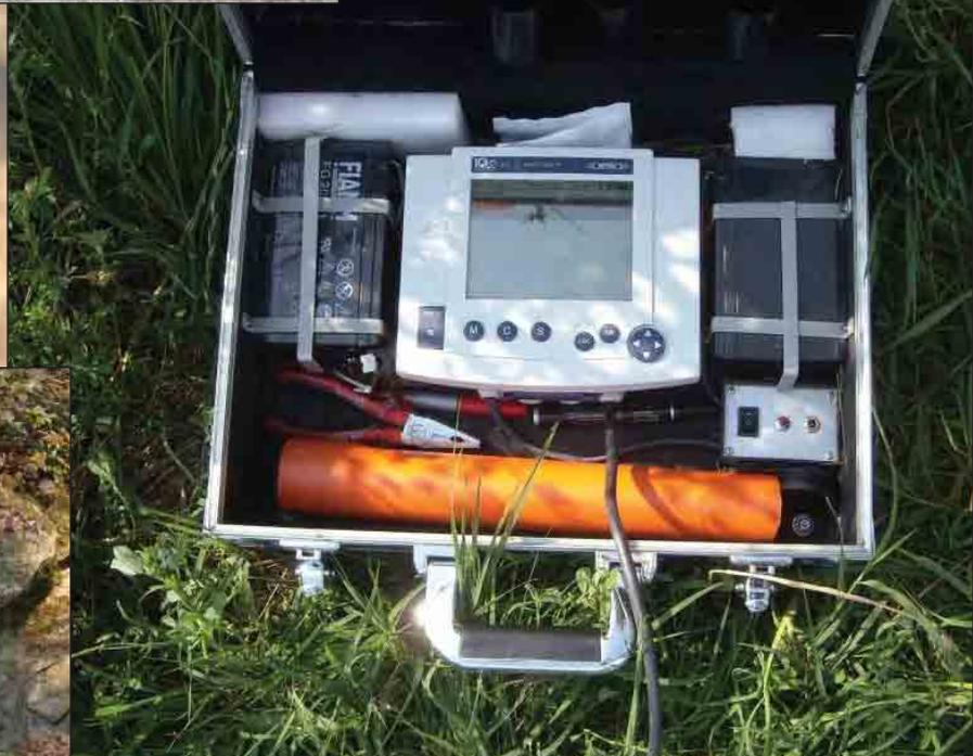
*Misurazione parametri fisici in sorgente (sonda multiparametrica HYDROLAB MS5).*
