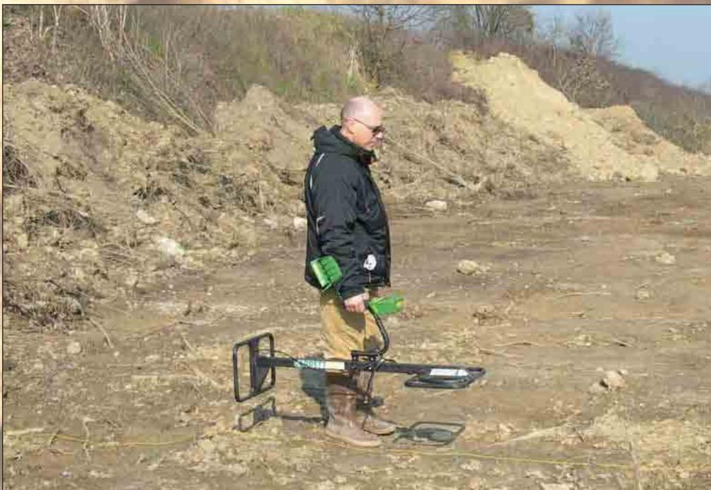
Le indagini Metal Detector vengono impiegate per la ricerca e localizzazione di oggetti metallici nel sottosuolo.
