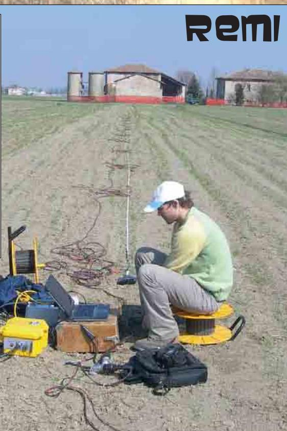
La determinazione delle Vs30 (velocità media di propagazione delle onde di taglio nei primi 30 metri di profondità) risulta essere fondamentale per la definizione dei suoli secondo l'inquadramento della nuova normativa tecnica in materia di progettazione antisismica.
